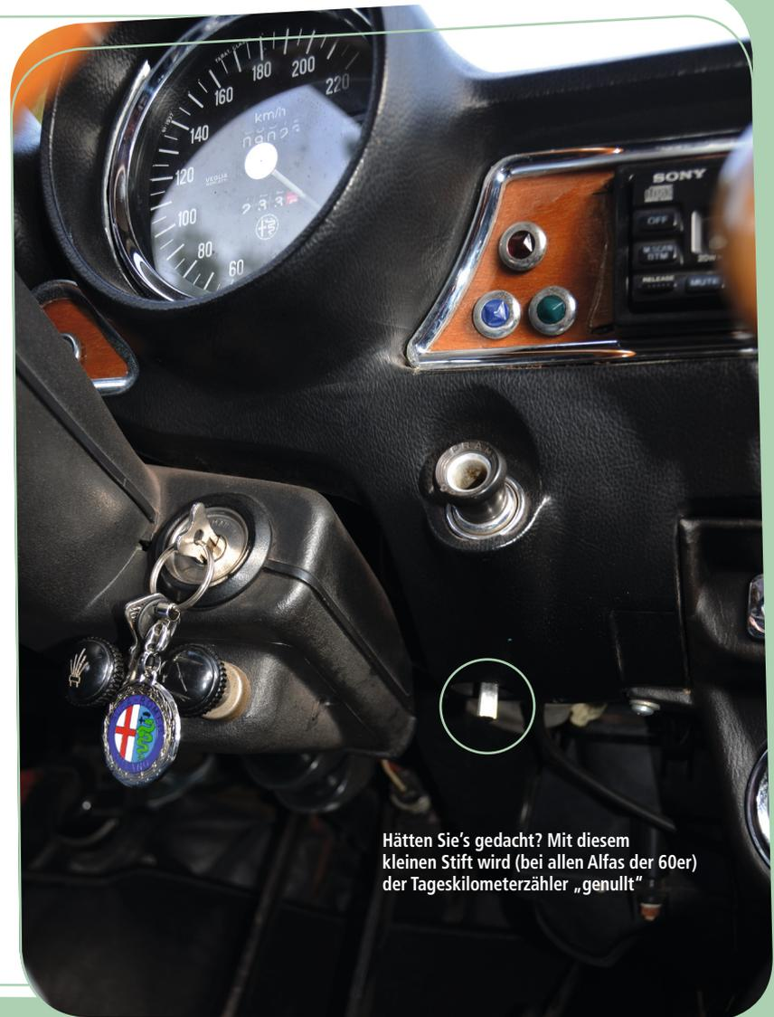
Hätten Sie's gedacht? Mit diesem kleinen Stift wird (bei allen Alfas der 60er) der Tageskilometerzähler „genullt“
